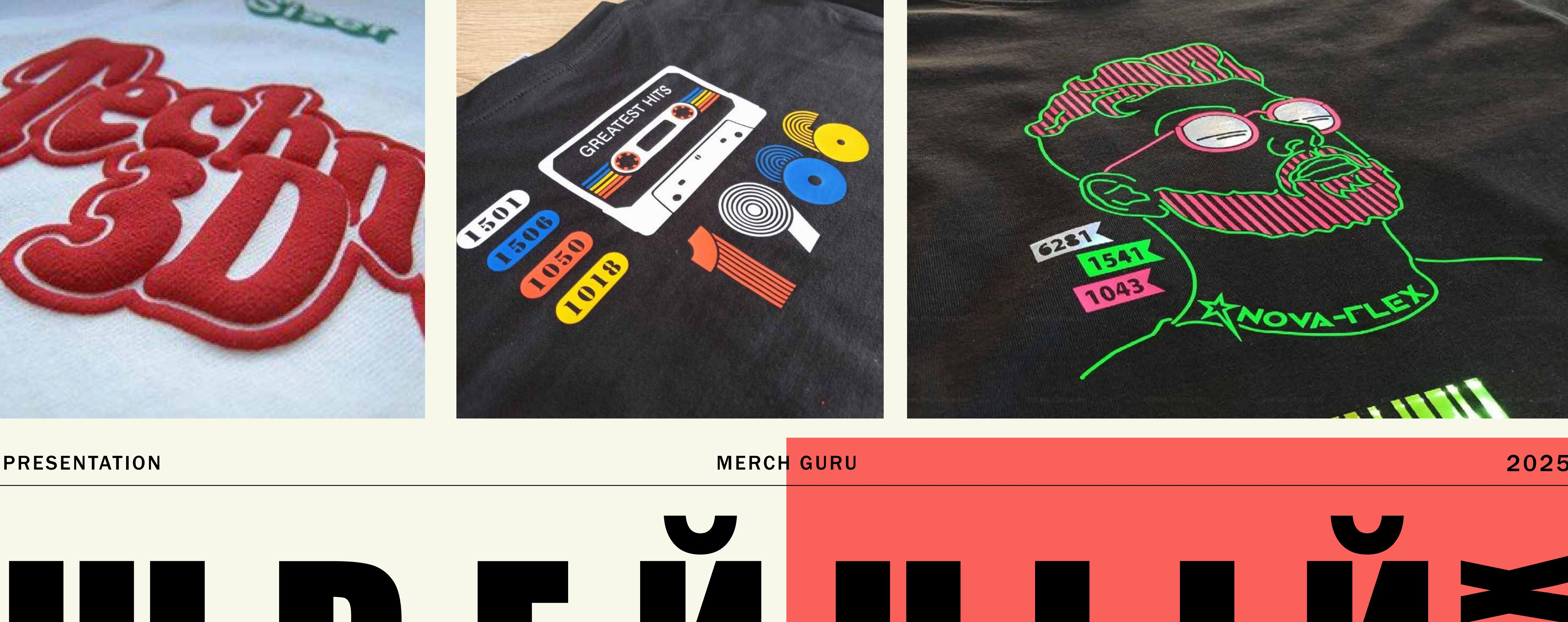
Шелкография, также известная как трафаретная печать, — это метод печати, при котором изображение наносится на различные материалы (бумагу, ткань, стекло, пластик и т.д.) через сетчатый трафарет. Краска продавливается через открытые участки сетки на запечатываемую поверхность.
